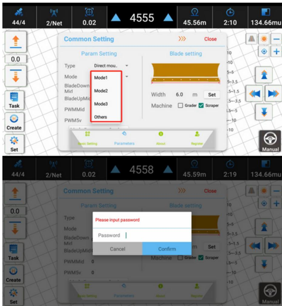
Quando si regolano i parametri, la velocità del motore deve raggiungere i 2000 giri/min o più.
