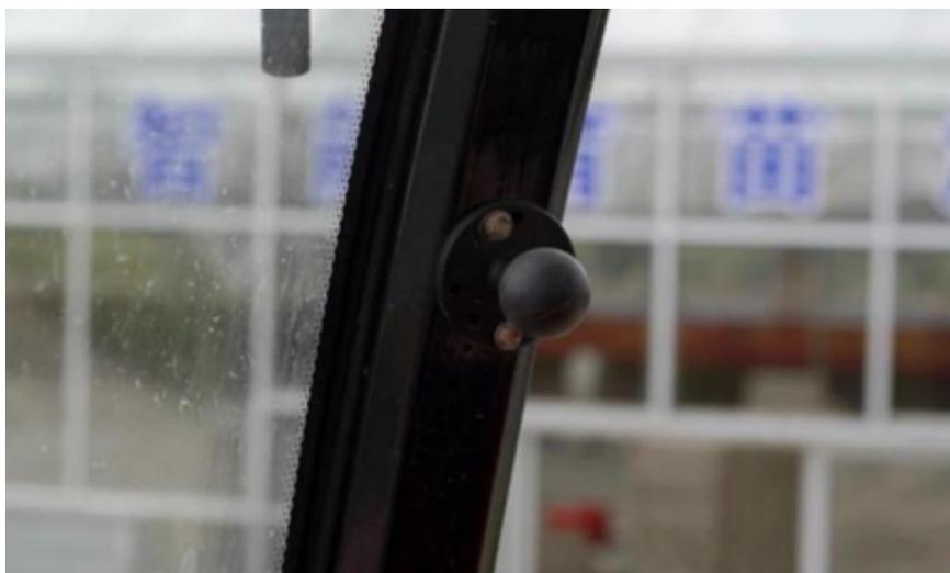
(3) Una volta completata l'installazione del monitor, se si ritiene che l'angolo di funzionamento non sia appropriato, è possibile allentare e regolare la staffa del monitor in una posizione adeguata;
